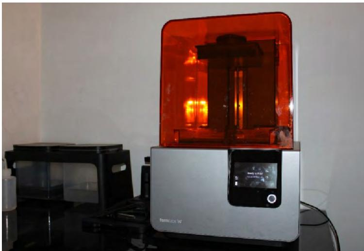
Figura 3. Técnica de la estereolitografía (SLA). A) Esquema del funcionamiento de la SLA <a href="https://formlabs.com/fr/blog/ultimate-guide-to-stereolithography-sla-3d-printing/#sla-systems">https://formlabs.com/fr/blog/ultimate-guide-to-stereolithography-sla-3d-printing/#sla-systems</a>; B) Impresora SLA Form2.
