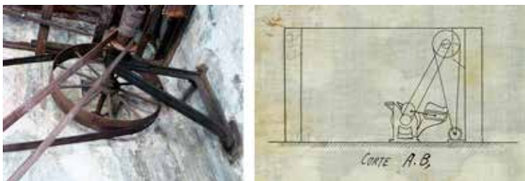
Figura 2. Rueda, eje y bandas de transmisión de la imprenta del Hospicio de las Mercedes, actualmente Hospital José T. Borda. Fotografía tomada por el autor; y Corte “A. B.” del plano T4 donde se ve una minerva motorizada (Exp. 7164/917, GCBA. AH-DGPMYCH).
