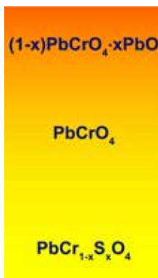
Figura 6. Esquema de las variaciones del \text{PbCrO}_4 sobre la base del agregado de \text{PbO} y \text{PbSO}_4 .
