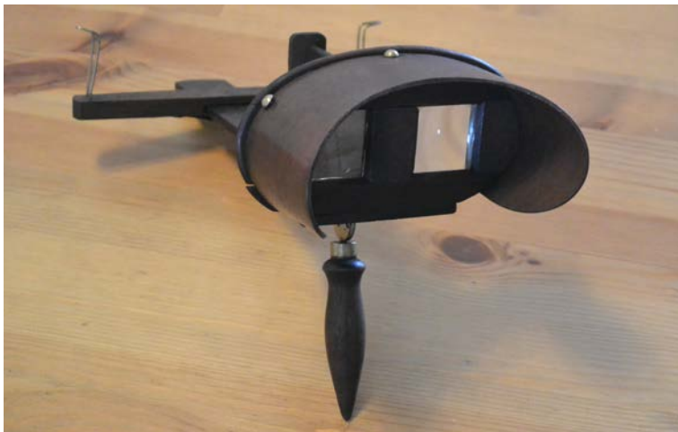
Figura 3. Estereoscopio Palo de Rosa de la firma E. & H.T. Anthony & Co. Dimensiones aproximadas armado: alto: 18,5; ancho: 18 cm.; largo: 32 cm. Patentado el 1° de diciembre de 1863 por Wheeler y Bazin y relanzado el 7 de mayo de 1878 con patente adquirida por E. & H.T. Anthony & Co. Esta muestra tiene la siguiente inscripción en bajorrelieve: PATD DEC.1.1863 I REISSUED MAY.7.1878. Colección del autor.
