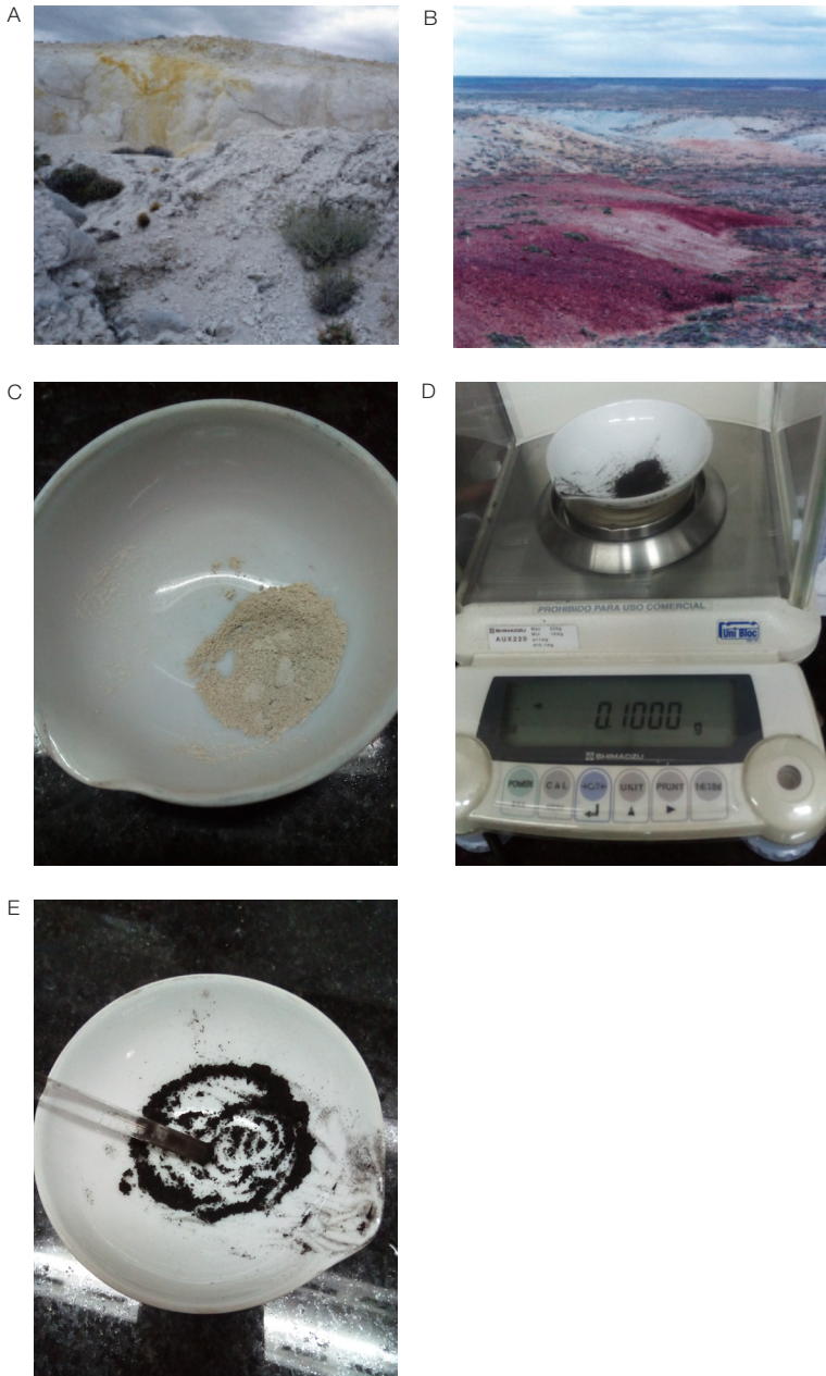
FIGURA. 9. (A) y (B) Ejemplos de las fuentes de minerales blanco y rojo de La María; (C) Mineral blanco luego de la molienda, (D) Pesaje en balanza analítica del pigmento negro; (E) Proceso de molienda de la carbonilla.
